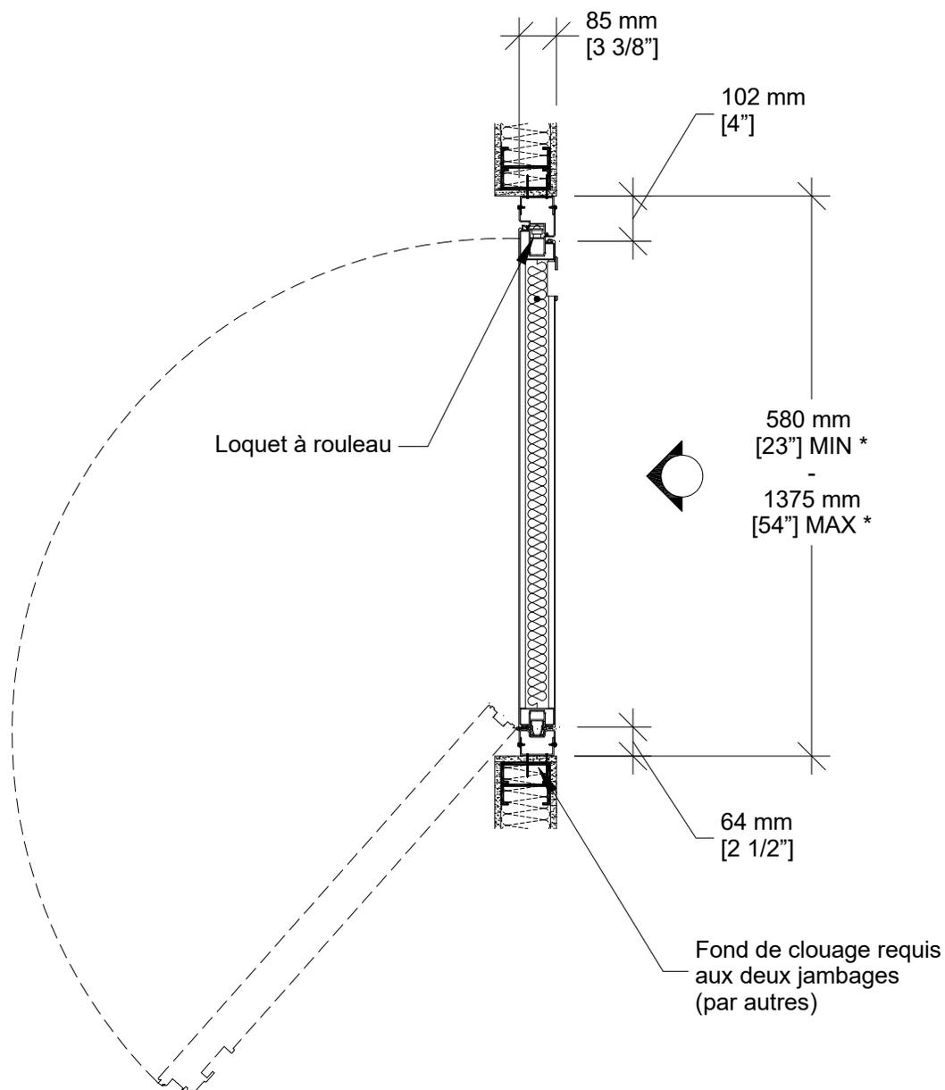
\* Les dimensions Min/Max sont des limites de fabrication et ne tiennent pas compte des conditions spécifiques à un projet donné.
