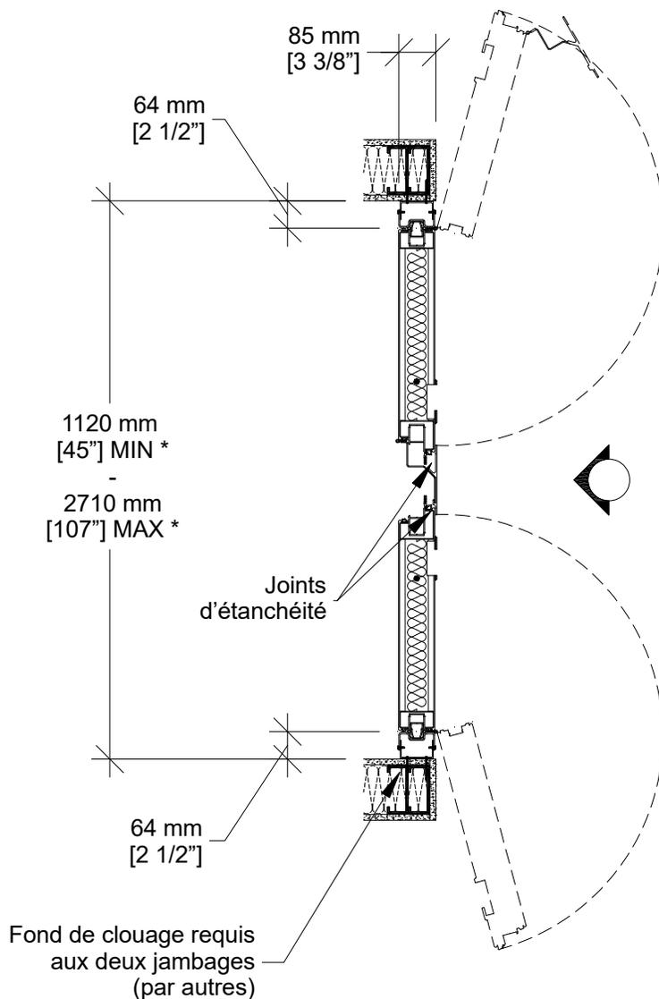
\* Les dimensions Min/Max sont des limites de fabrication et ne tiennent pas compte des conditions spécifiques à un projet donné.
