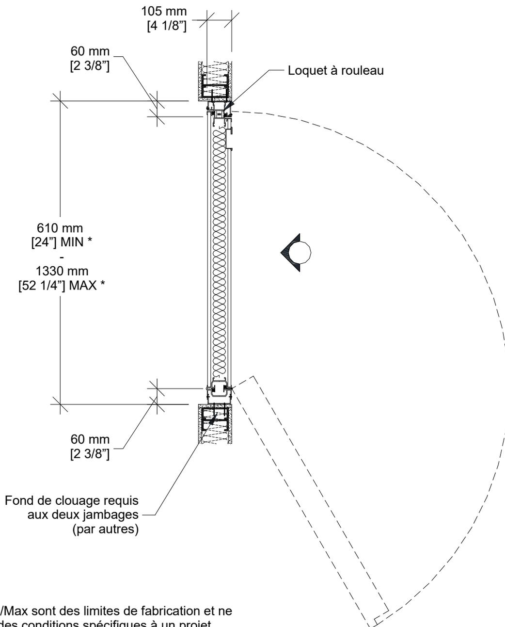
\* Les dimensions Min/Max sont des limites de fabrication et ne tiennent pas compte des conditions spécifiques à un projet donné.
